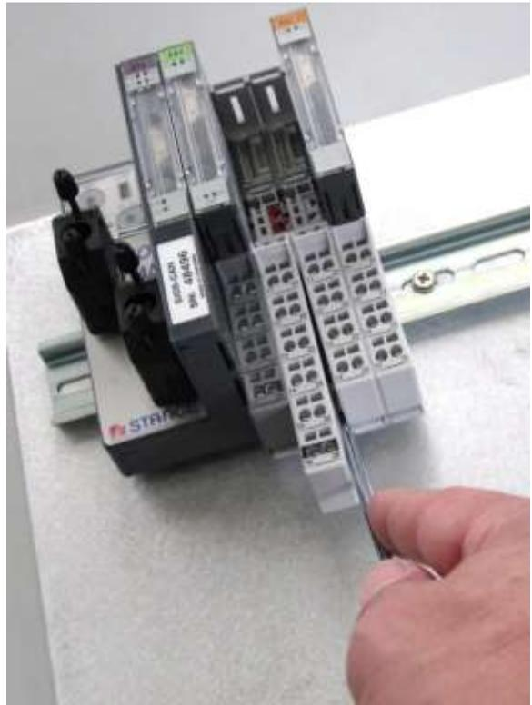
Ein einzelner Modulträger wird von der Normschiene gelöst, indem mit einem geeigneten Schraubendreher die Rastfeder auf der Rückseite entriegelt wird. Gleichzeitig kann der Träger von der Schiene genommen werden.
