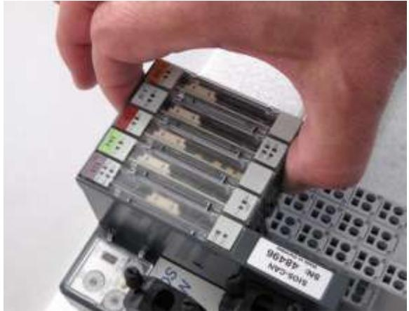
Werden ein oder mehrere Module gezogen, verhindert eine Kodierung (siehe Markierungen im Bild), dass ein falscher Modultyp auf den freien Platz gesteckt wird.
