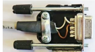
Abbildung 4; CAN-Leitung SE-Gerät <-> SIOS-Gateway
